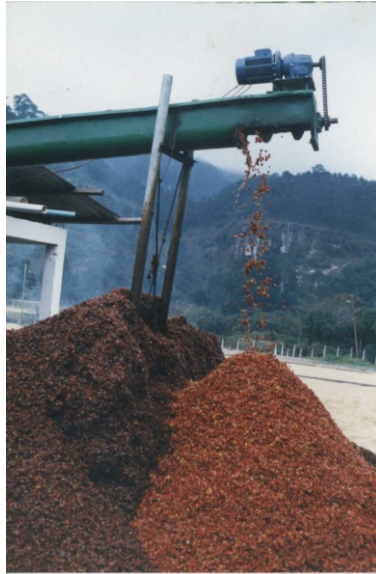
Figura 13.3 Transporte mecánico de pulpa, con un tornillo helicoidal
