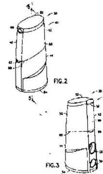
Resumen: Un dispositivo alimentador (20) para introducir productos químicos de tratamiento en una corriente de agua recirculante de una pileta de natación (26). El dispositivo alimentador (20) incluye un recinto (40) con una porción superior (42) una inferior (44); una tolva similar a un embudo (70) con paredes laterales (72) y una parte inferior abierta (74) que forman la parte interior de la porción superior (42).
