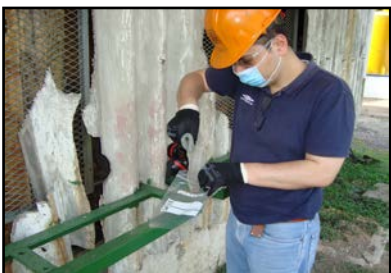
Fotografía No. 6. Toma de muestra fachada frontal (pared)
