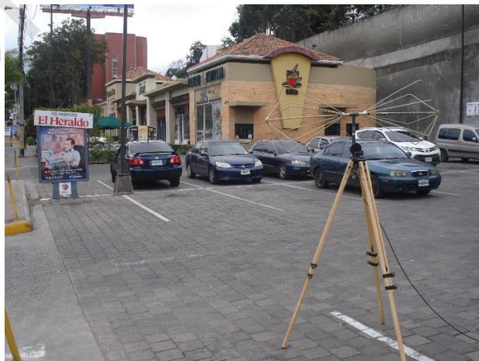
**Fotografía No. 3:** Antena tipo expandible ubicada en cercanías del Estadio Nacional, realizando mediciones en campo en las bandas de Radiodifusión FM, Televisión VHF bajo y alto.
