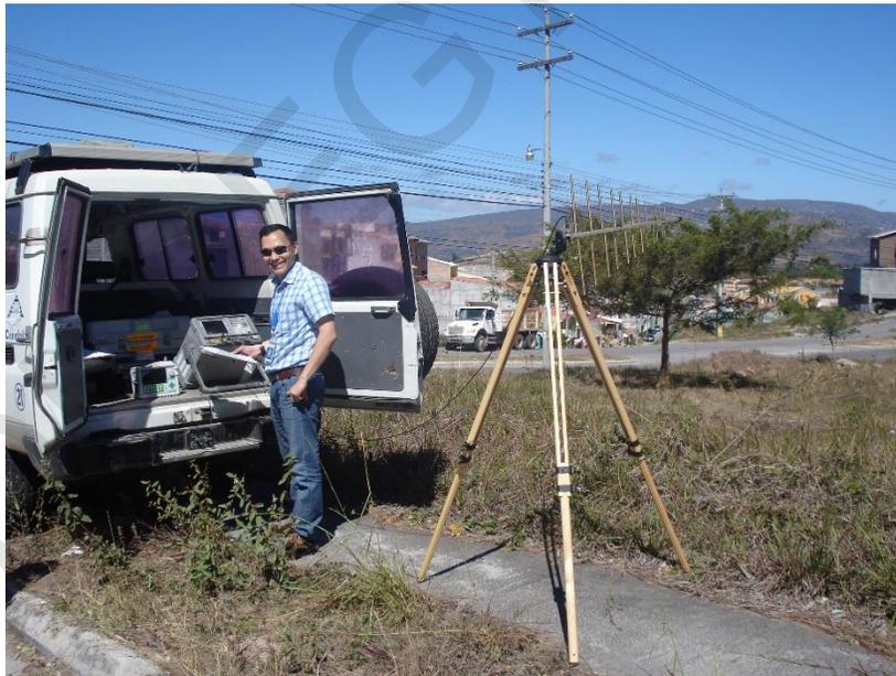
**Fotografía No. 5:** Antena tipo Log-Periódica ubicada en cercanías al colegio Técnico Luis Bográn, El Carrizal, realizando mediciones en campo en las bandas de Televisión UHF, Telefonía Celular y PCS.
