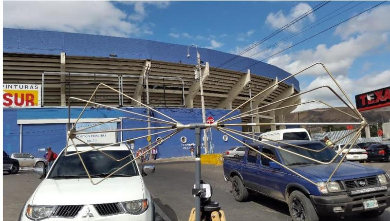
**Fotografía No. 4:** Antena tipo Log-Periódica ubicada en cercanías del puente a residencial Las Uvas, realizando mediciones en campo en las bandas de Televisión UHF, Telefonía Celular y PCS.
